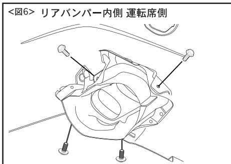
⑧マフラーエクステンションを(左右)リアバンパーに取り付けます。まず製品傷付き防止の為に、バンパー表面のマフラーエクステンション取付部周辺をマスキングテープ等で保護します。テールエクステンションをバンパー裏側から通し、内側取付け部の製品とテールエクステンションの内側と外側および底面を付属のM6フランジボルトにて取り付けます。(図6参照)
