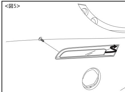
⑦別途お買い求め頂きました、バンパーリフレクターを(左右)取付けます。取付けは純正同様、バンパー表面よりリフレクターを差し込み、バンパー裏側から車両ビスにて1箇所取り付けます。(図5参照)
