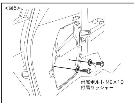
⑪カーゴスペースサイドインナーより、付属のM6×10ボルト/付属ワッシャーにてバンパーサポート取付穴を利用して、当社バンパー埋込みナット部分を左右2箇所づつ取付けます。(図8参照)
