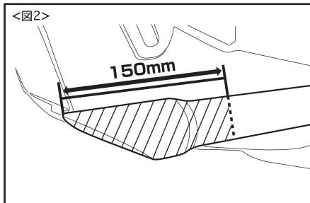
④純正マフラー出口パイプを図のように、後端部から150mmの位置の所で、パイプに対して水平になるようにカットします。(図2参照)また、カットした切り口部分は耐熱性のある塗料等で紡錘処理を施してください。
