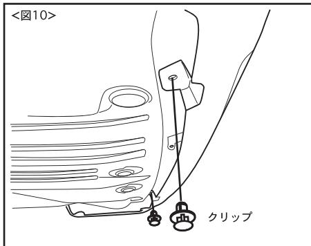
⑬バンパー底面を2箇所、車両クリップを使用して取付けます。(図10参照)
