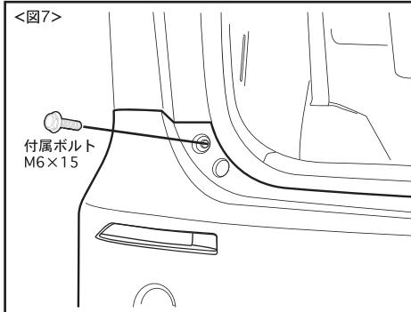
⑨付属の両面テープをバンパー内側折り返し部分(車両設置部分)に貼り付け、取付穴位置(バンパー埋込みナット)はボルトが通るようキリ等で穴開けしてください。
