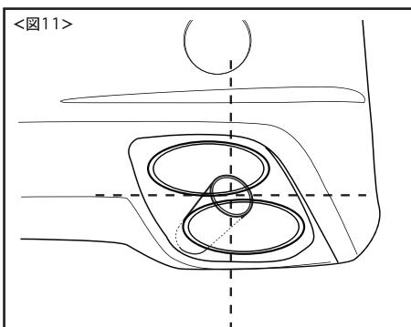
⑭マフラーattachメントの位置出しを行います。マフラーエクステンション出口内のセンター部分にしっかりとくる位置で、干渉等が無い位置にしっかりと位置決めし、attachement取付ボルトを締めこんでください。(図11参照)
