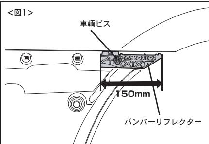
③サイド部分およびリア部分のバンパーサポートを取り外し、サイド部分は図のように先端部分から150mmのところでカットします。カット後、車両ビスにて1箇所取付けます。(図1参照)
