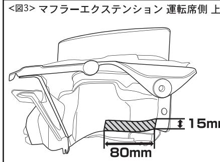
⑤別途お買い求め頂きました、マフラー・エクステンションを(左右)図のように、上側を前端部から15mm幅で図の位置(斜線部)をカットしてください。(図3参照)
